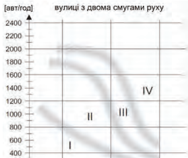
Рис. 1: Діапазони навантаження для попереднього вибору форми велоруку на міських вулицях із двома смугами руху (переходи між діапазонами навантаження не є жорсткими кордонами)
